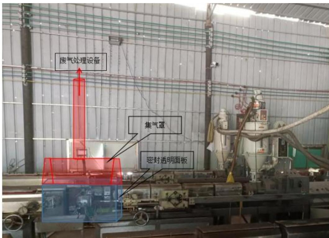
图 4-2 挤出机废气集气罩设置情况
