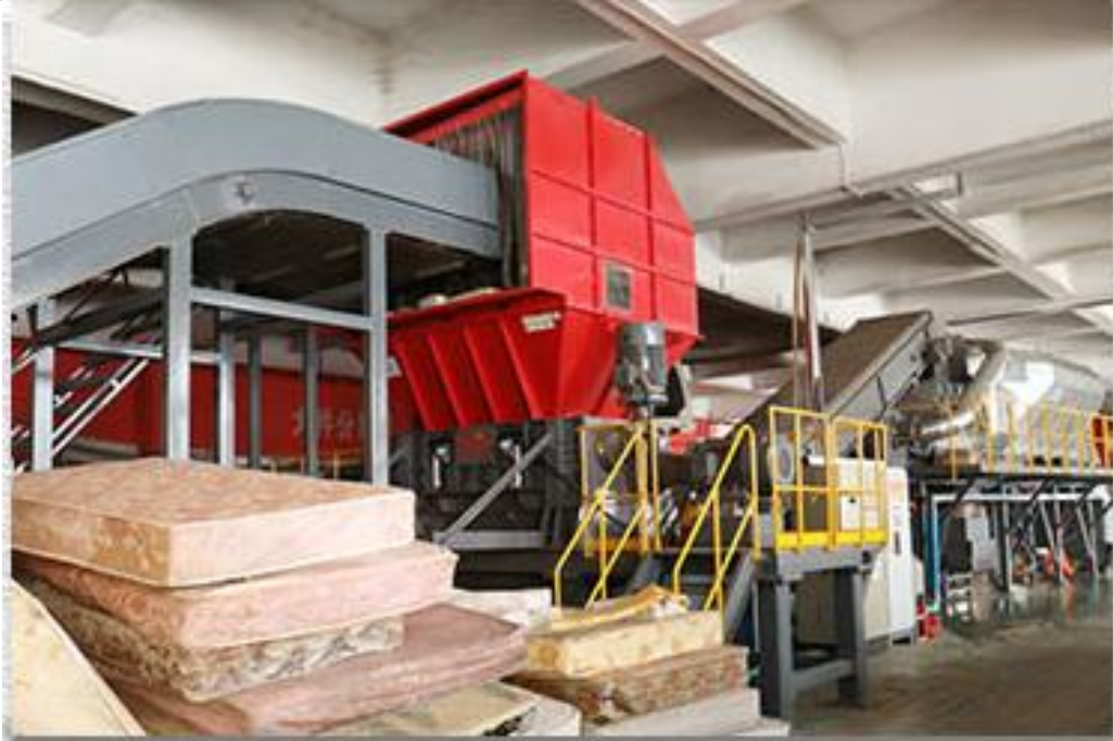
图 4-2 项目 SRF 与 RDF 燃料制备设备进料输送传送带
