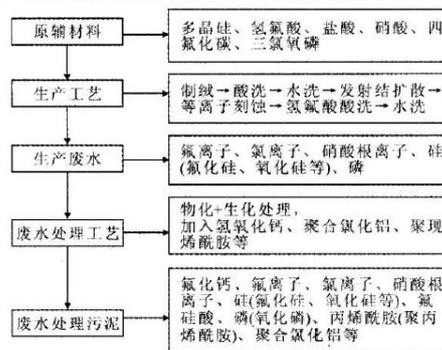
图1 物质迁移和转换路线
