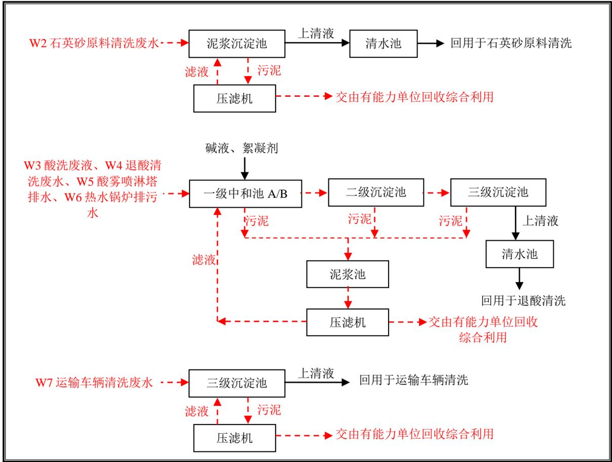
图 4-1 本项目生产废水处理系统工艺流程图
