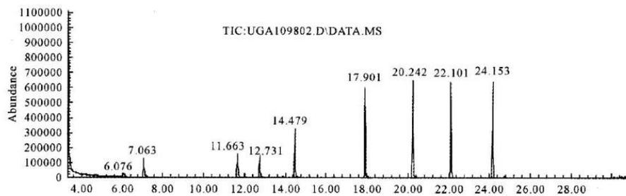
图1 样品 VOCs的总离子流图(TIC)
