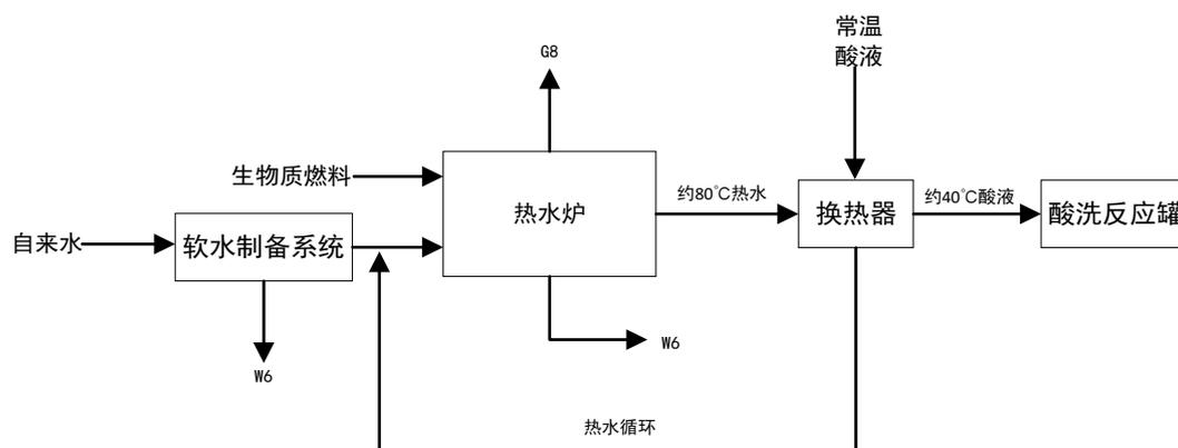
图 2-3 热水锅炉生产工艺流程
