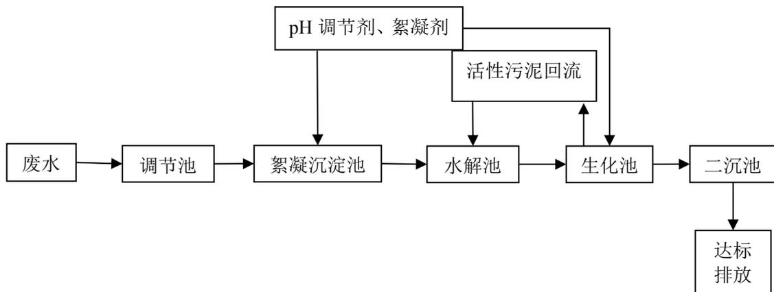
图 4-1 污水处理工艺流程图
