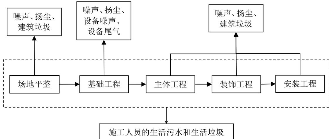
图 2-1 施工期施工流程及产污环节简图
