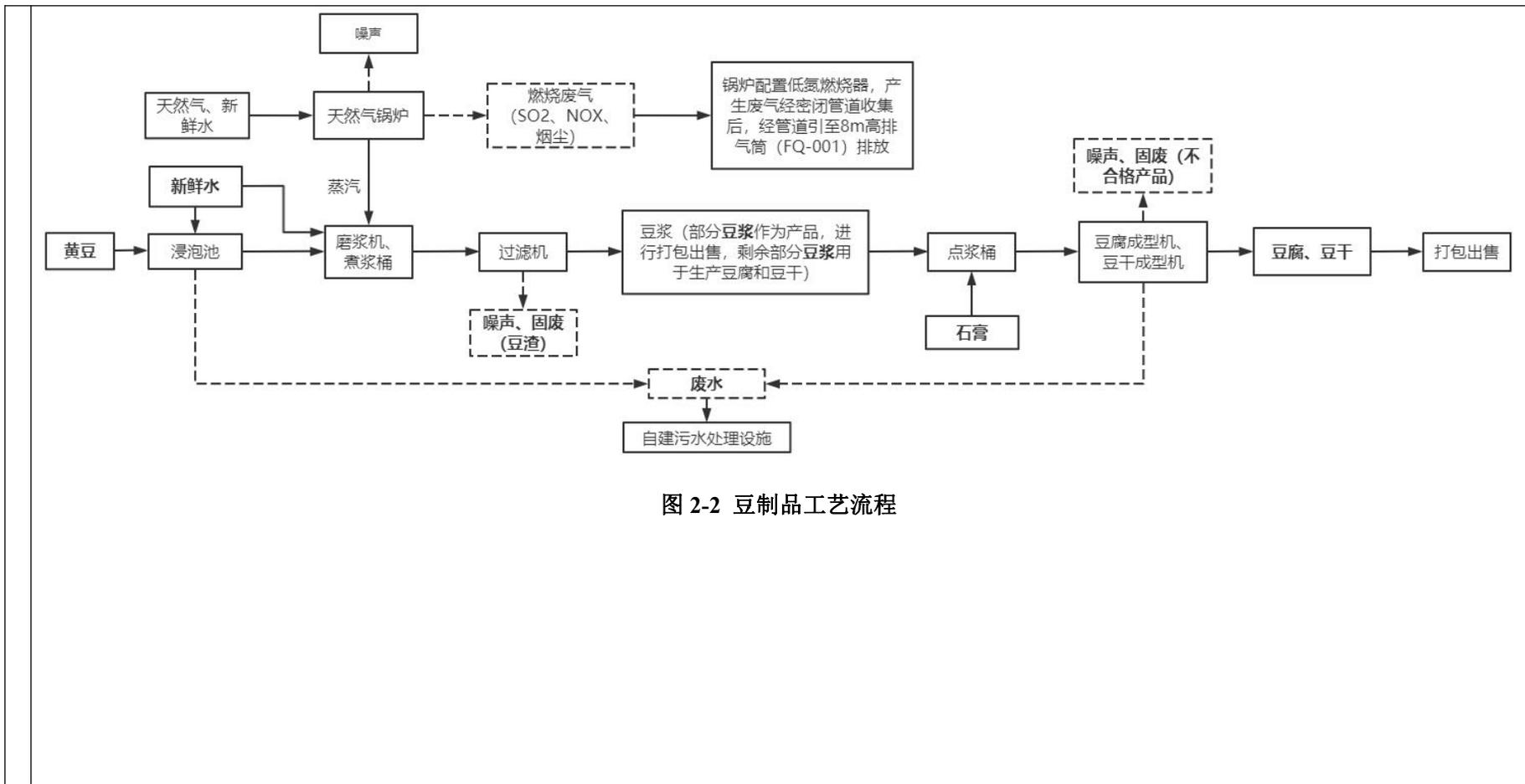
图 2-2 豆制品工艺流程
